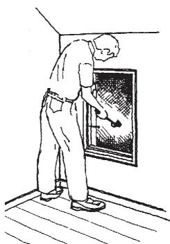
(SWE) Montera väggluckan i hålet genom att kila fast den med träkilar. Kontrollera att karmen är i vinkel samt att karmen sitter jäms med väggens insida. Spika (skruva) karmen med 100 mm långa spikar (skruvar), 2 st på varje längssida.
